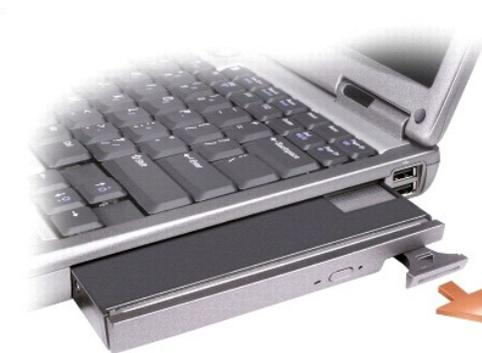
4. Schieben Sie das neue Gerät in den Modulschacht, bis es hörbar einrastet.
