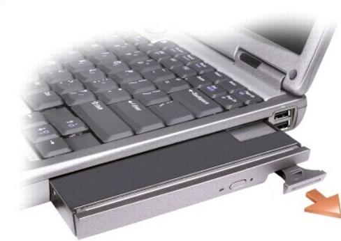
4. Schieben Sie das neue Gerät in den Modulschacht, bis es hörbar einrastet.
