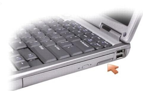
3. Ziehen Sie das Gerät aus dem Modulschacht heraus.
